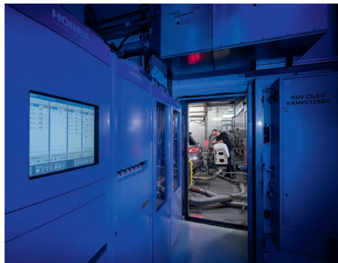
Im Rahmen einer RDE-Straßenmessung wird bei Mercedes-Benz die PEMS-Anlage (Hintergrund) vor jeder Messreihe gegen die Prüfstandmesstechnik (Vordergrund) validiert
